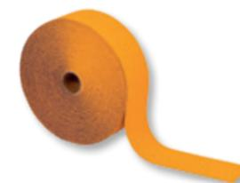
» Retroreflektierende, entfernbar, orange Markierungsfolie für Baustellen, verstärkt mit eingebautem Netz, erhöhte Nachtsichtbarkeit bei Nässe
