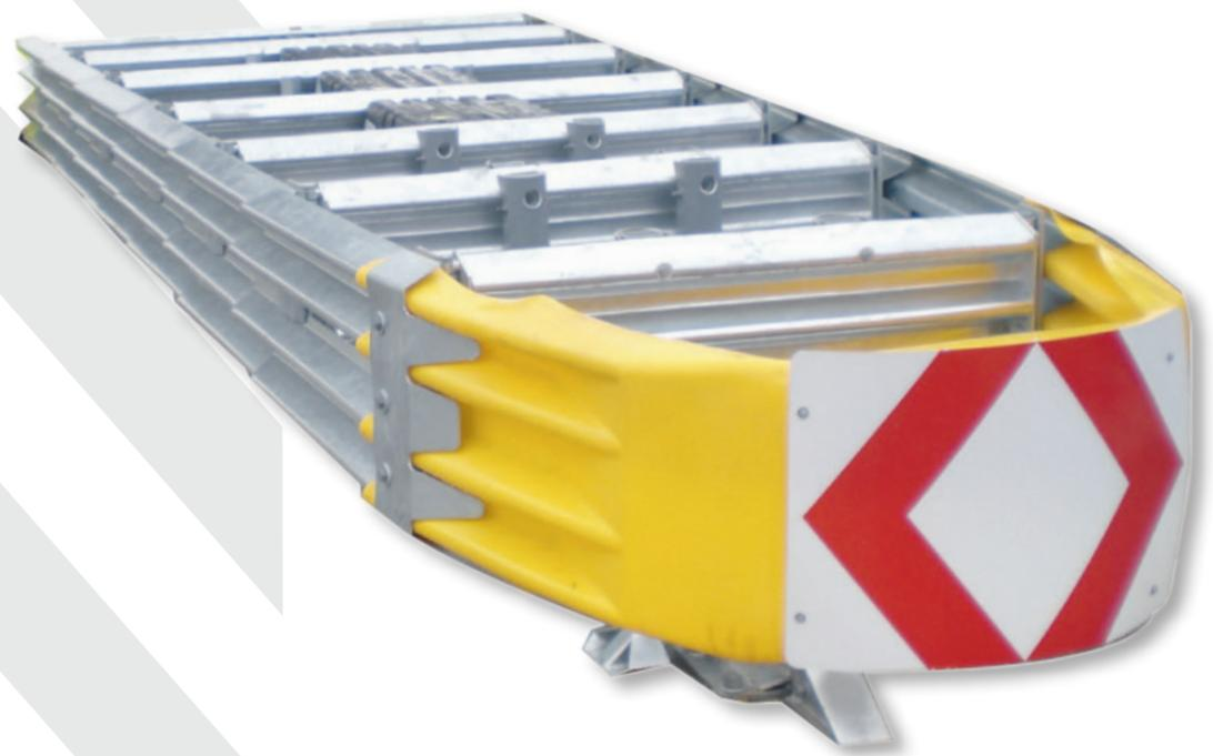
QUADGUARD CEN ist ein **Anpralldämpfer** aus verzinktem Stahl, der **gem. EN 1317-3 sowohl als zurückleitendes (Typ R) als auch als nicht-zurückleitendes (Typ NR)** System geprüft ist. Der Anpralldämpfer verfügt über **Dämpfungselemente (Cartridges)** welche die Energie eines Anpralls absorbieren. Das System ist **bidirektional**
