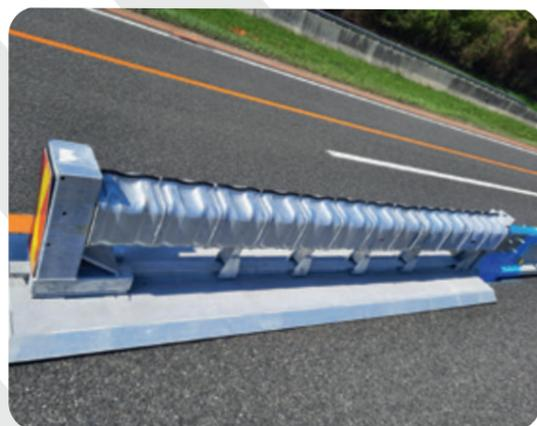
**SMA Taurus** ist der erste zurückleitende Anpralldämpfer für Baustellen der **mit nur 4 Stk. Ankern** auskommt und sowohl als **zurückhaltendes System (Typ R)** als auch als **nicht-zurückleitendes (Typ NR)** System geprüft ist. Das System wurde für den Einsatz im Baustellenbereich entwickelt und kann in wenigen Minuten montiert werden. Der Anpralldämpfer dient **zum Schutz von abgesenkten Enden der Schutzwandssysteme** aus Stahl oder Beton im Baustellenbereich.
